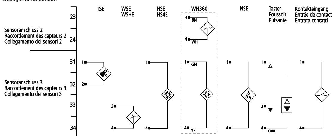
Pro Sensoranschluss, darf nur ein Sensor angeschlossen werden.
